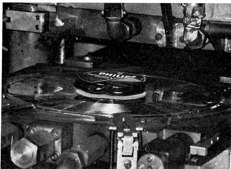
Fig. 19. — La galette de matière préchauffée entre les deux étiquettes avant la fermeture du moule et le pressage.
