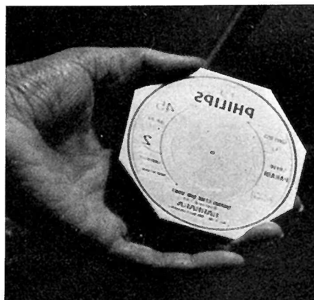
Fig. 11. — Cliché en relief remplaçant les étiquettes pour les 45 tr/mn avant son centrage et son détourage. ▼
