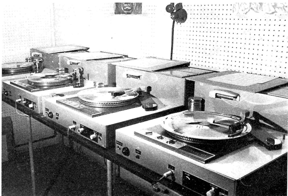
Fig. 9. — Platine de lecture automatique chargée de la détection des défauts sur les mères
