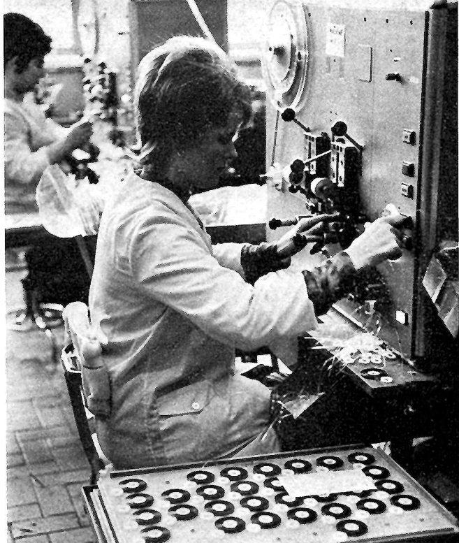
Fig. 22. — Mise en galettes de chaque programme destiné aux cassettes préenregistrées.
