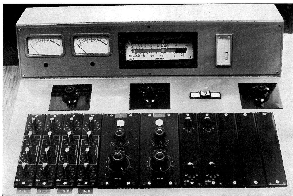
Fig. 10. — Console de contrôle de la gravure NEUMANN ; de gauche à droite, les 2 VU-mètres, les 2 modulomètres de crête et le phasemètre. (Photo Aubert-Philips).
