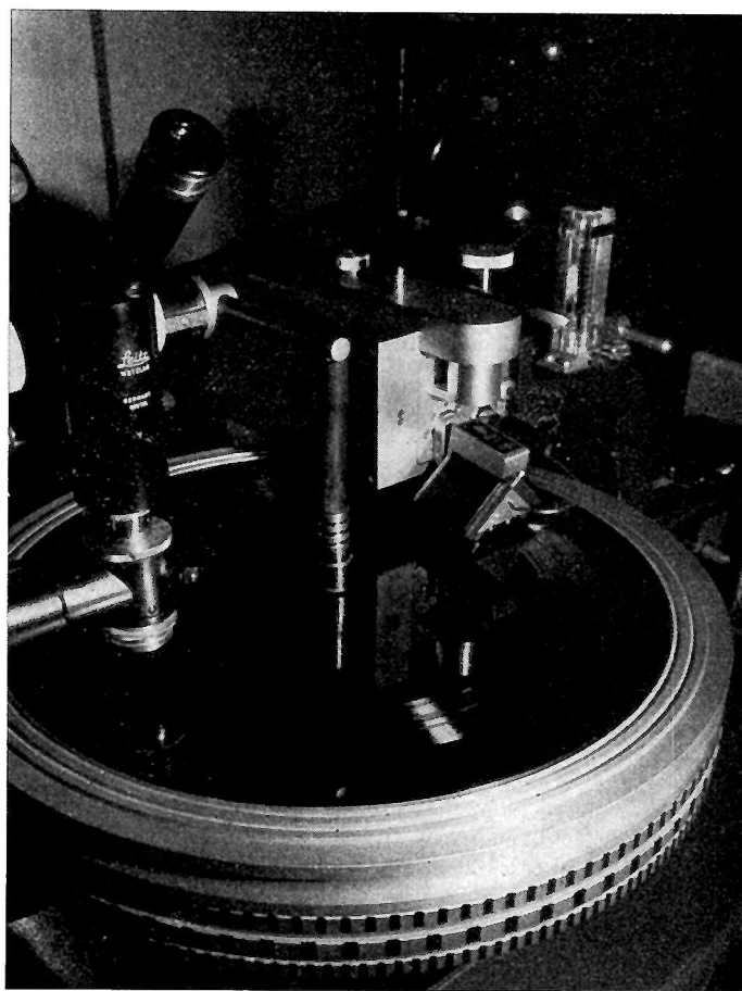
Fig. 14. — Vue de la tête de gravure NEUMANN SX 68 et du plateau d'entraînement du disque souple. On remarque au centre la liaison vers la pompe à vide permettant l'aspiration du disque sur le plateau, à gauche le microscope de contrôle des sillons. (Photo A.J. Andrieu).
