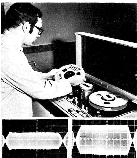
L'oscilloscope montre (à droite) le gain en niveau de sortie par rapport à une bande standard.
