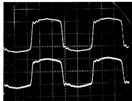
Fig. 13. — Restitution de signaux carrés à 1 kHz par le phonolecteur GRADO modèle F2, sur l'un et l'autre canal. L'amélioration par rapport au modèle FTR est évidente. Les suroscillations se manifestent vers 20 kHz et sont beaucoup mieux amorties.
