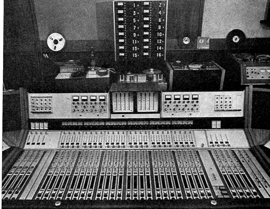
Fig. 4. — Partie centrale de la console de prise de son du studio n° 1; en arrière plan le magnétophone Studer 16 pistes (photo J. Aubert-Philips).
