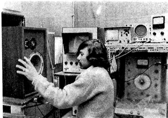
Chaque enceinte acoustique produite par la firme Acoustic Research est testée en chambre anéchoïque (à gauche sur la photo) à la nouvelle usine d'Amersfoort (Pays-Bas).
