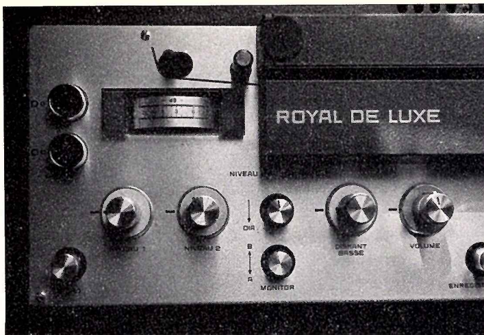
Fig. 4. — On distingue à gauche du modulomètre les deux prises « micro ». En dessous, les réglages jumelés du niveau d'enregistrement (micro et PU/Radio mélangeables en stéréo) et à droite, les réglages de tonalité et de volume à la lecture.
