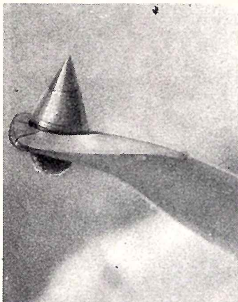
Fig. 4. — Vue très agrandie de la pointe en diamant équipant le phonolecteur Shure M91E, qui révèle très nettement le mode de fabrication, où un fragment de diamant, convenablement orienté quant à la position de ses axes cristallographiques, est enchassé à l'extrémité d'un fin tube métallique, qui lui sert de support pendant et après les opérations de taille et polissage. Ce procédé qui réduit considérablement le prix de revient des pointes en diamant (quitte à les alourdir légèrement) fournit depuis quelques années des pointes biradiales, dites aussi elliptiques, dont Shure a immédiatement doté certains de ses modèles d'assez grande diffusion, tels que « M 31 » et « M 32 » (revue du SON n° 200).
