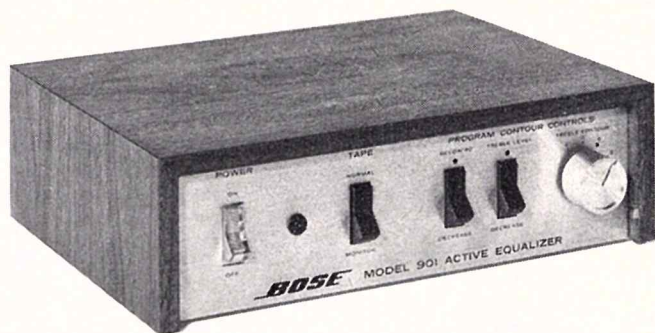
Fig. 4. — Le boîtier correcteur actif, prenant place entre préamplification et amplification de puissance.
