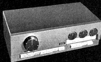
QUAD 33 Preampli à circuits enfichables Particularité datant de 1950 Filtre à double réglage (fréquence de coupure et pente d'atténuation)
