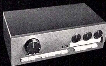
QUAD 33 Preampli à circuits enfilables Particularité datant de 1950 Filtre à double réglage (fréquence de coupure et pente d'atténuation)
