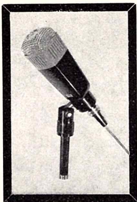
Fig. 1. — Le microphone cardioïde DU25C. On notera les « prises de pression » caractéristiques, sous forme de fentes à l'arrière du grillage.
