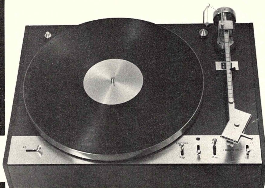
Fig. 1. — La table de lecture « Eramatic » de la firme française ERA, qui unit les avantages d'une mécanique tourne-disques de grande classe à moteur synchrone de faible vitesse angulaire et transmission par courroie élastique (33 et 45 tr/mn), à ceux de l'automatisme intégral des manœuvres du bras, pour les trois diamètres de disques normalisés (17, 25 et 30 cm). Les commandes s'effectuent par cinq clés : changement de vitesse, interrupteur secteur, mode de fonctionnement, sélection de diamètre du disque et mise en route ou répétition. Le bras, à poutre en H et plaquette porte-cellule amovible, est du type à pivot « flexiprène », utilisé par ERA pour plusieurs réalisations antérieures. On aperçoit aussi le compensateur de poussée latérale à fil de nylon et masselotte, à régler en fonction de la force d'application de la pointe lectrice (un détail vaut ici d'être noté, la potence amovible où passe le fil de nylon est maintenue en position convenable par un petit aimant logé dans son pied); enfin, en haut et à gauche le téton recevant le centreur 45 tours. « Eramatic » est évidemment livrée soigneusement réglée par son constructeur; mais il est facile de retoucher, par le jeu de deux vis facilement accessibles, la hauteur de soulèvement du bras au-dessus du plateau, comme la pose de la pointe lectrice au début du disque.
