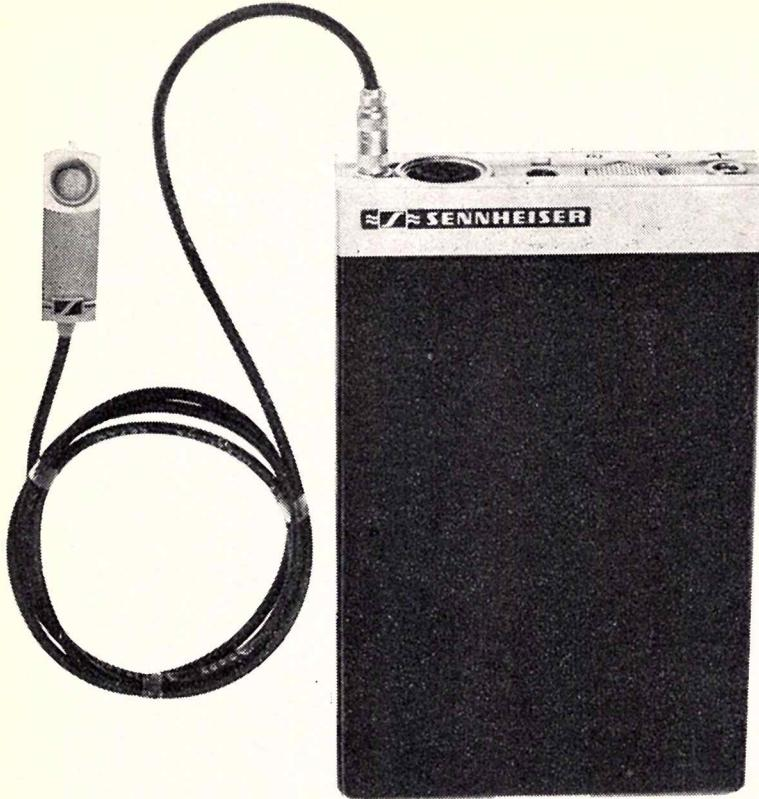
Fig. 1. — Micro-émetteur SK 1007 de Sennheiser, au côté du microphone électrostatique miniaturisé « MK 12 ».
