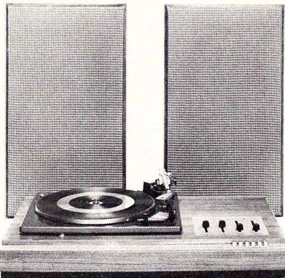
Chaîne haute fidélité compacte comprenant un tourne-disques Garrard SP 25 avec tête Pickering, un amplificateur 2 x 10 W, 16 transistors, réglages de volume et de tonalité par potentiomètres rectilignes, compensation physiologique, sélecteur d'entrée à pousoirs, et deux enceintes de 25 dm<sup>3</sup> (HP 21 cm CABASSE) GARANTIE TOTALE 2 ANS. 1 750 F.
