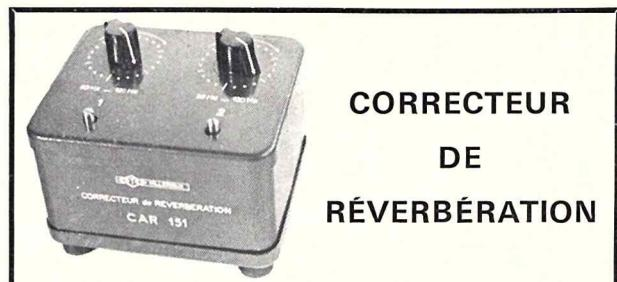
Fig. 6. — Correcteur double Milleroux à 24 positions et interrupteurs de mise hors service (réf. CAR 81 pour charge 4 à 8 Ω — CAR 151 pour charge 8 à 16 Ω) permettant la correction d'une fréquence de réverbération sur chaque voie stéréophonique ou la correction de deux fréquences sur une seule voie.
