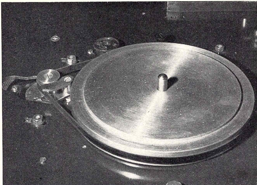
Fig. 2. — Le plateau (poids total 1,650 kg) du nouveau tourne-disques de P. Clément se compose d'une couronne de 30 cm en aluminium (fondue puis rectifiée) reposant sur une poulie de grand diamètre solidaire de la platine, formant le centre du plateau qu'entraîne directement par courroie rectifiée, en néoprène, le moteur synchrone à faible vitesse angulaire (250 tr/mn environ).
