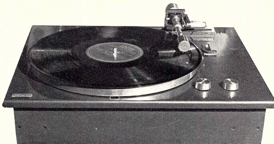
Fig. 1. — La nouvelle table de lecture phonographique, à bras radial électroniquement asservi de Pierre Clément, ici équipée d'un phonolecteur PCL7. La platine avec moteur et bras est suspendue sur ressorts. Au premier plan, se trouvent les deux boutons de commande, l'un commutateur 33-45 tr/mn; l'autre réglage fin par potentiomètre ( \pm 2\% de la valeur nominale). A l'arrière, s'aperçoit la fente par laquelle le bras est relié à son mécanisme d'entraînement. A droite du plateau, rabattu sur la platine, un dispositif de sécurité servant au blocage du bras pendant un transport éventuel.
