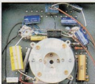
Un câblage "en l'air" autour de la 845.
