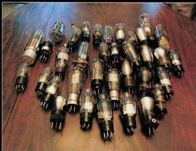
Quelques lampes triodes à chauffage direct pour application en basse fréquence. Certaines d'entre-elles sont toujours d'actualité.
