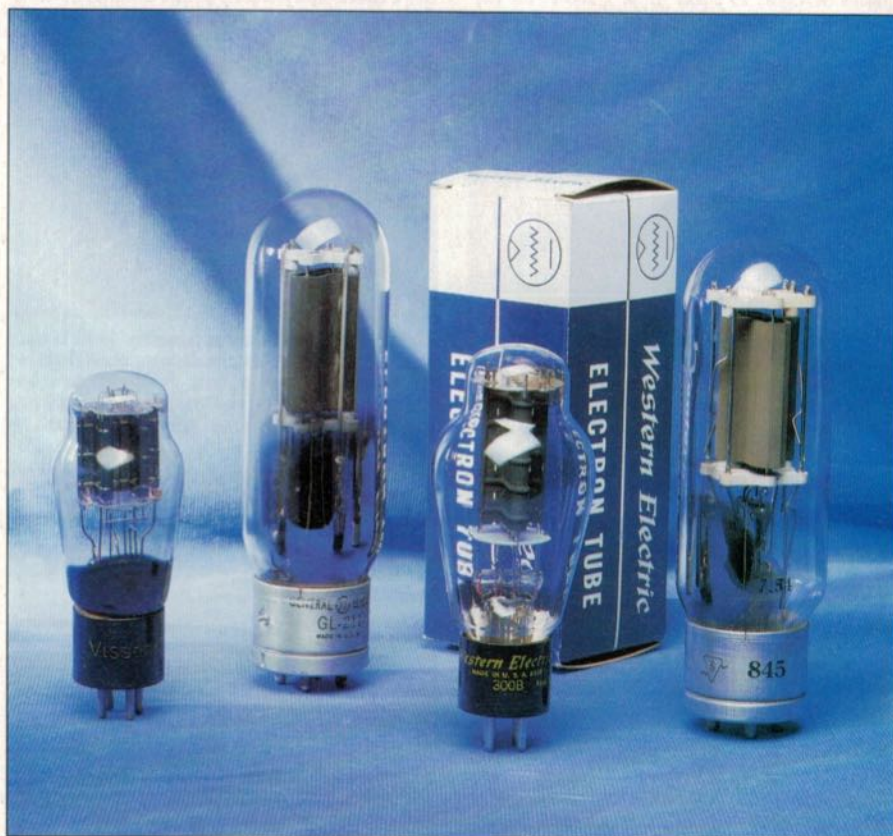
Figure 1: Les vedettes les triodes les plus courantes utilisées aujourd'hui soit en Push-Pull soit en mono triodes. De gauche à droite: 2A3-211/VT4C 300B 845.
