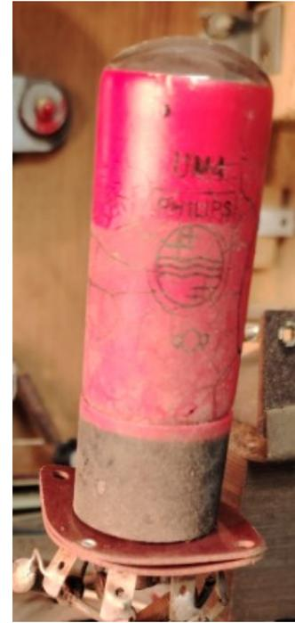
Ces tubes étaient utilisés dans les montages dits « Tous courants », sans transformateur d'alimentation. Le danger absolu car le secteur peut se retrouver sur le châssis...
