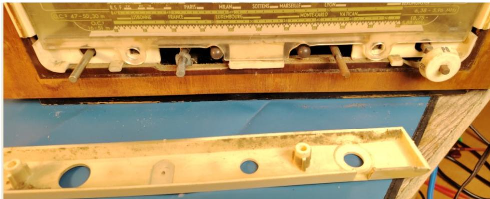
Vis de maintien de la ficelle de manœuvre de l'aiguille du cadran. Fragile!
