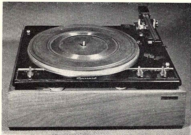
Fig. 1. — La table de lecture automatique Garrard « AP 75 », montée sur socle. On notera le plateau de diamètre 262 mm (850 g en aluminium coulé et rectifié), le bras de lecture formé d'une poutrelle plate, amincie en sa partie médiane, et les trois manettes de commande à l'avant (de gauche à droite sélection de vitesse et diamètre, commande manuelle, commande automatique).
