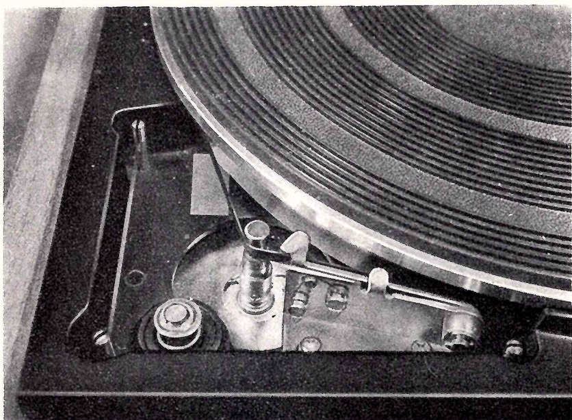
Fig. 2. — Poulie à gradins d'entraînement de la courroie et fourchette de changement de vitesse, commandée par la touche de gauche, figure 1.
