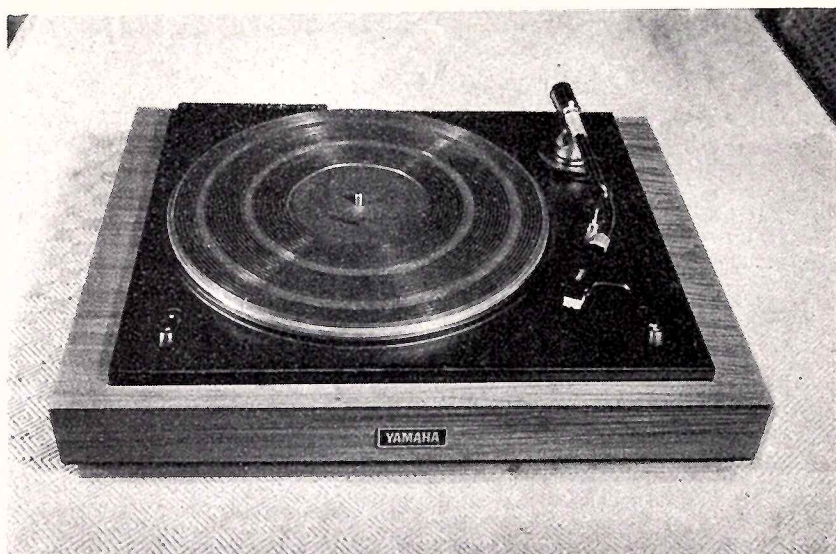
Fig. 1. — Table de lecture automatique YP-70 de Yamaha (elle se complète normalement d'un couvercle en matière plastique transparente, qui peut être abaissé pendant le fonctionnement). Les commandes s'y réduisent à deux touches : celle de gauche, à deux positions, détermine la vitesse de rotation adoptée (33 ou 45 tr/mn) ; celle de droite (Play-Off), à enfoncement et retour automatique, enclenche une série d'opérations automatiques : démarrage du moteur, connexions à l'amplificateur et pose du bras. A la fin du disque, ou après action sur la touche de droite, pour le rejet, elle soulève le bras, le ramène sur son support et arrête le moteur.
