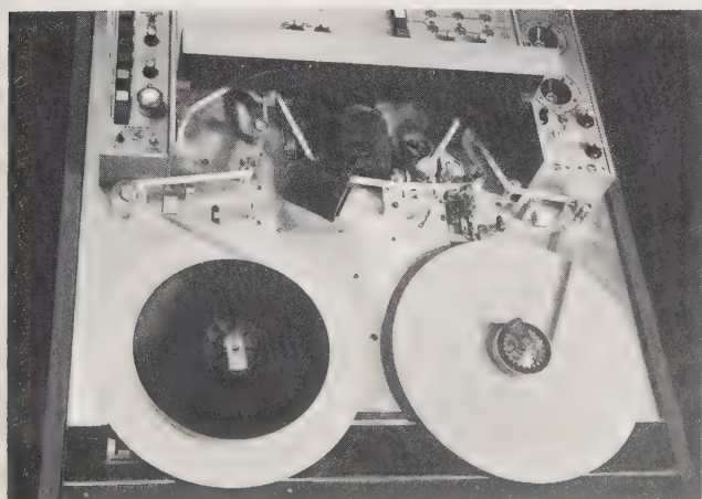
Fig. 6. — Trajet du film après chargement des bobines.
