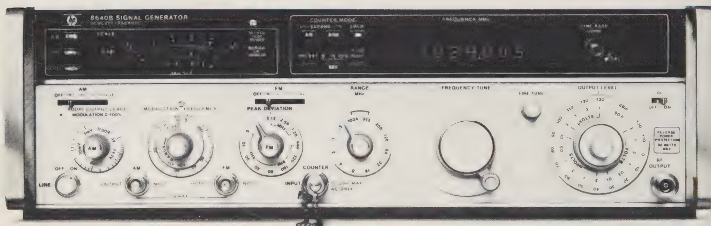
Le HP 8640B avec ses options 001, 002 et 003 : de 0,5 à 1024 MHz.
