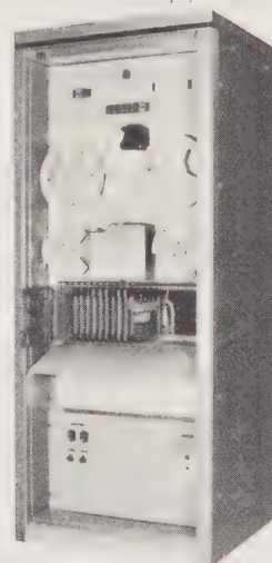
Fig. 4. — Programmeur de corrections pour télécinéma.
