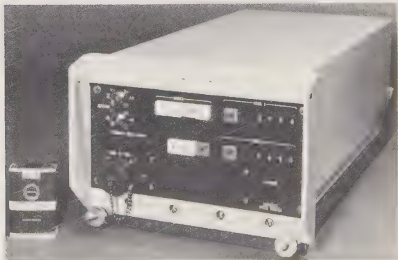
Fig. 7. — Interogateur/récepteur/décodeur (LMT-SECRÉ). Équipement monté dans le Crotale.
