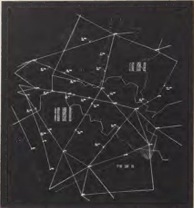
Fig. 11. — Image synthétique avec étiquette identité (altitude des avions répondant aux radars secondaires) (TVT).
