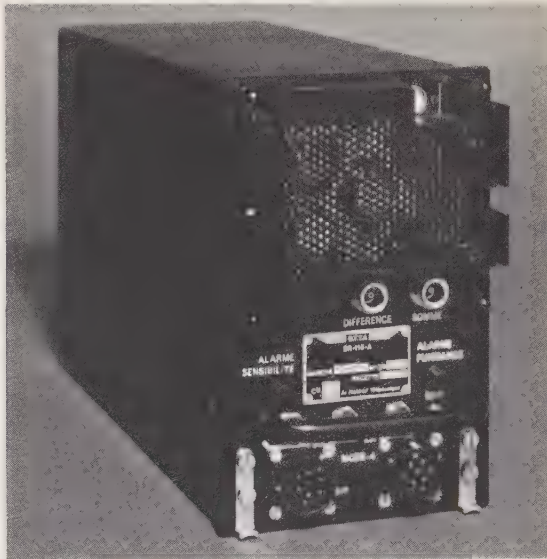
Fig. 6. — Interogateur NRAI 3A (LMT). Équipement bord, monté sur Bréguet Atlantique.
