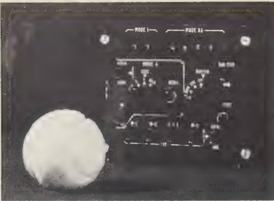
Fig. 8. — Transpondeur IFF de bord LMT (NRAI 4A). Panneau BNAÉ, circuits intégrés, puissance d'émission 500 W).
