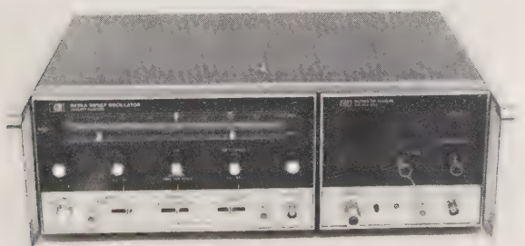
Fig. 1. — Le tiroir 86290 A est destiné à être utilisé avec le vobulateur 8620 C. Quatre bandes de fréquences peuvent être sélectionnées à l'aide d'un commutateur situé sur la face avant de l'appareil, il s'agit des bandes 2-6,2 ; 6-12,4 ; 12-18 et 2-18 GHz.
