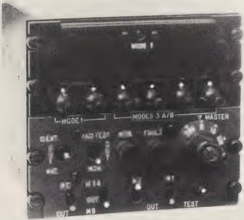
Fig. 9. — Transpondeur IFF de bord EMD 3300 (de caractéristiques correspondantes à celles du précédent).
