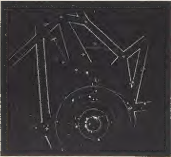
Fig. 10. — Image en vidéo brute d'échos radar primaire et radar secondaire après décodage passif (les échos décodés sont repérés par des traits d'épaisseur et intervalles variés) (TVT).
