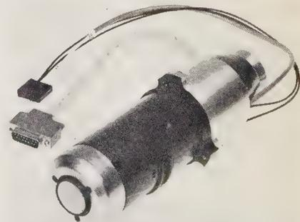
Le tube intensificateur d'images possède une photocathode trialcaline de grande sensibilité. Le tube Plumbicon a un canon anticômète permettant de supprimer les effets dus aux suréclaircissements, et une source de lumière de polarisation destinée à éliminer le trainage lors des faibles éclaircissements.
