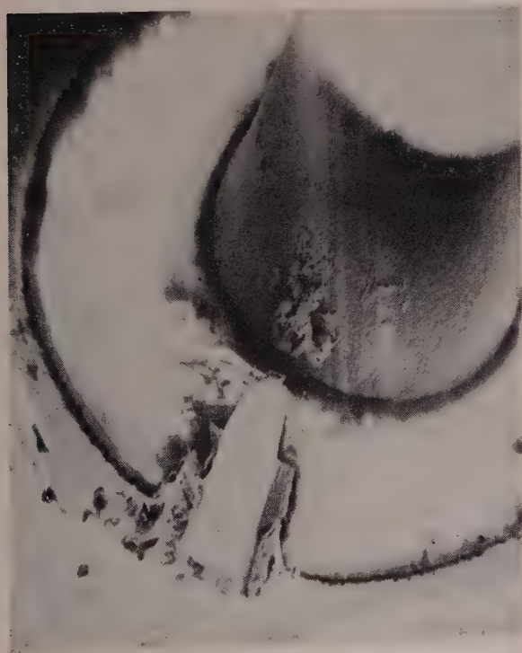
FIG. 7. — Montage d'une diode tunnel dans son boîtier. G = 70
