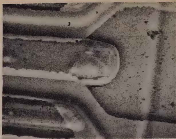
FIG. 4. — Ouverture de métallisation sur une marche d'oxyde. G = 2 000
