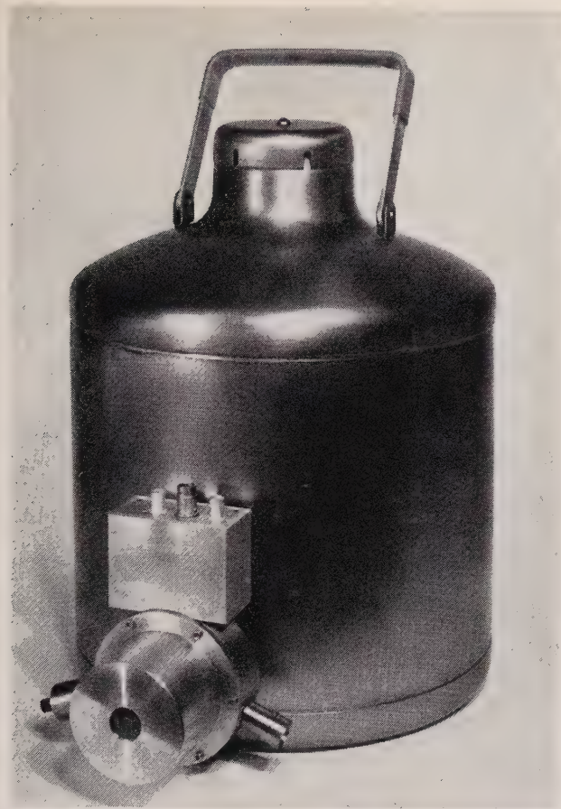
FIG. 1. — Cryostat à « doigt » froid latéral avec fenêtre de Be de 12 \mu\text{m} d'épaisseur.
