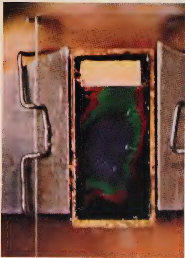
FIG. 4. — Vérification du fonctionnement d'un isolateur hyperfréquence à ferrites à déplacement de champ.
