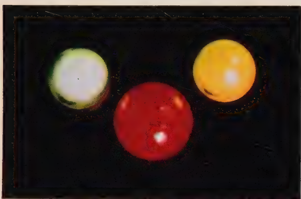
FIG. 1. — Diode électroluminescente de couleur rouge à Ga As P.
