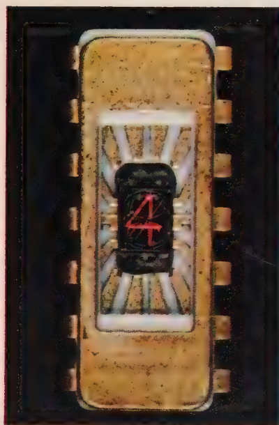
FIG. 2. — Illustration des trois couleurs actuellement disponibles à l'aide de dispositifs électroluminescents : Ga P (jaune et vert) Ga Al As (rouge).
