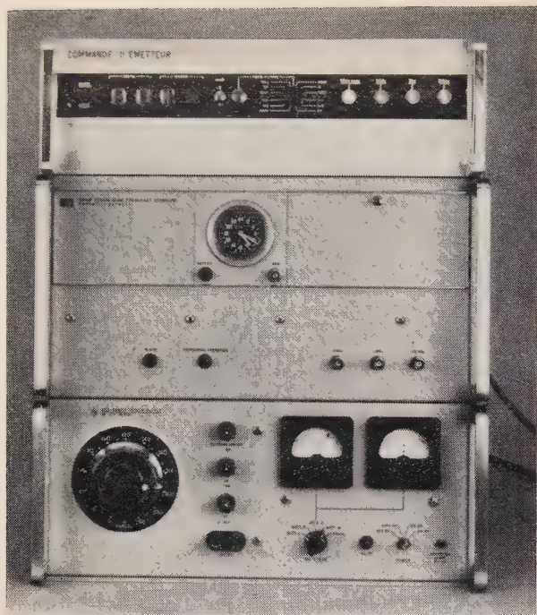
FIG. 3. — Horloge à jet de césium.
