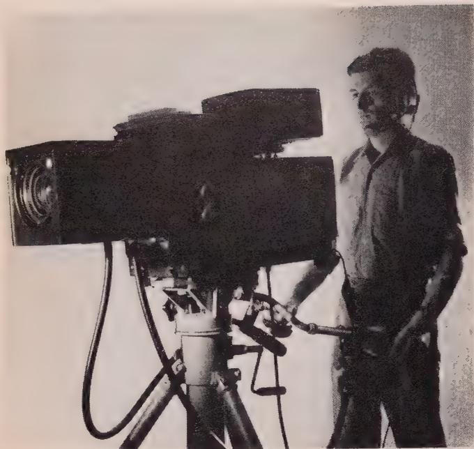
La nouvelle caméra de télévision en couleur Thomson-CSF utilisant un câble de très petit diamètre et comportant des systèmes de réglage automatiques.
