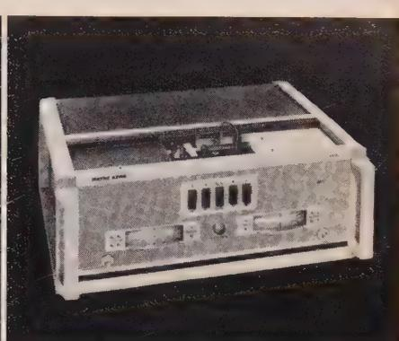
**Pont RLC 1 % - 100 kHz à 10 MHz** Mesure des parties réelles et imaginaires de toute impédance ( $\pm C \pm G$ ) dans la gamme :  $10^{-3} \text{ pF}$  à  $1 \text{ mF}$  -  $100 \mu\Omega$  à  $100 \text{ M}\Omega$  -  $10 \text{ pH}$  à  $10 \text{ H}$  - Configurations série ou parallèle - Indépendance vis à vis de la fréquence du fait de l'utilisation d'étalons de capacité, d'inductance et de résistance - Compensation très simple des capacités parasites par décalage du zéro du pont.
