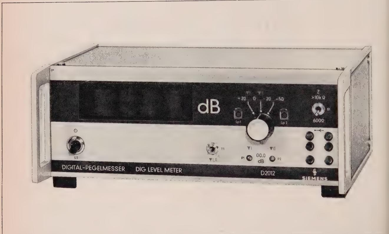
A partir d'un appareil de laboratoire de haute précision, le D 2010/D 2014, Siemens a développé un décibel-mètre digital simplifié qui allie la commodité d'emploi à une très bonne précision de mesure. Sous un aspect compact et léger (circuits intégrés), il est conçu d'après les principes de base du modèle D 2010/D 2014 : quantification de la grandeur de mesure à partir d'une fonction logarithmique tension/temps.
