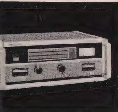
**Source Détecteur 100 kHz - 100 MHz** - Accord unique valable à la fois pour la source et le détecteur. Tension de sortie maximale : 2 V dans  $75 \Omega$  - Atténuateur bouton poussoir à 3, 6, 10 et 20 dB. Stabilité maximale du détecteur :  $1 \mu\text{V}$  à 100 MHz à  $20 \mu\text{V}$  à 100 MHz - Atténuation maximale du gain de 80 dB en 4 fois 20 dB
