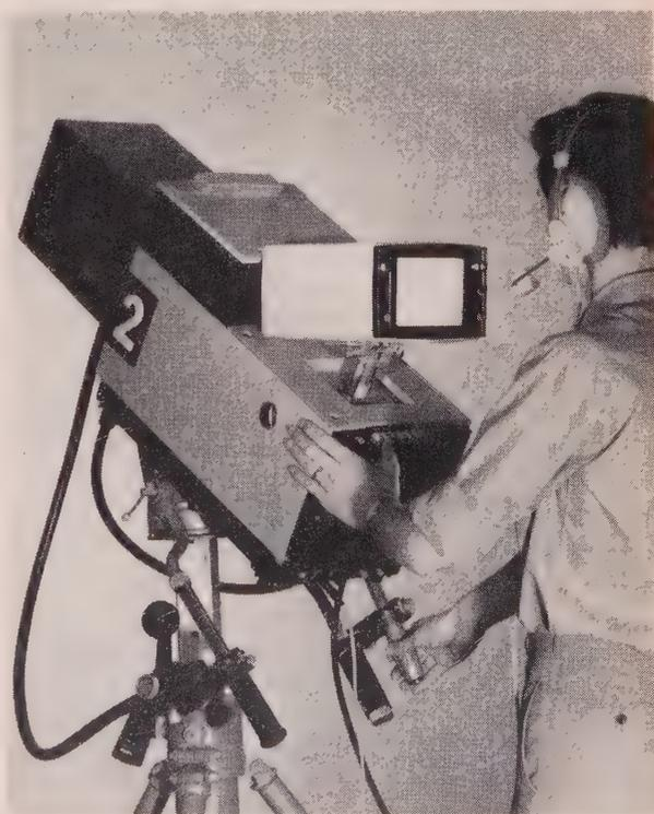
FIG. 1. — La caméra TTV 1515 en utilisation (contre plongée).
