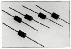
ment 6A, la série WAB. En boîtier plastique axial de 9,6 mm de long et 6,6 mm de diamètre, ces diodes redressent à 50 °C un courant de 6 A. A 100 °C, le courant redressé est encore de 3 A. Le courant inverse maximal à 25 °C est de 5 µA; à 100 °C il est de 150 µA au nominal de la tension. Le courant répétitif maximal est de 50 A et le courant maximal admissible sur un cycle est de 400 A. Les diodes de la série WAB existent jusqu'à 800 V de tension inverse.
