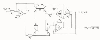
$Q_1 - Q_4$ : CA 3046  $R_1 - R_4$ : 20  $k\Omega$  1 %
