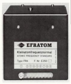
rubidium, la lumière est absorbée et le courant chute dans le détecteur. Cet effet est utilisé, après amplification, pour corriger la fréquence du quartz et obtenir une excellente stabilité du signal étalon. L'oscillateur délivre un signal sinusoïdal de 10 MHz (10/5/1 et 0,1 MHz pour le modèle FRT). Il a une stabilité à court terme de 10<sup>-12</sup>, une consommation de 13 W et un volume de 1 dm³.
