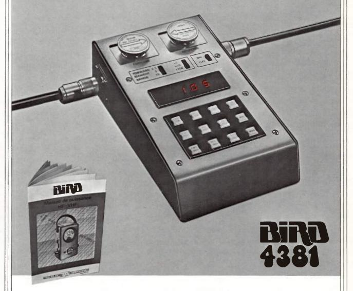
Le BIRD 4381 est un multimètre HF portatif piloté par micro-calculateur. Il mesure les puissances directe et réfléchie, CW, crête, dBm, de 100 mW à 10 kW sur une bande de fréquences de 450 Hz à 2,3 GHz. Il calcule aussi le R.O.S., et met en mémoire les mini et les maxi de la mesure.
