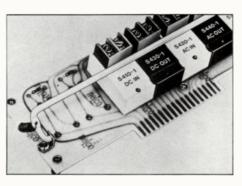
signaux logiques compatibles aux entrées microprocesseurs ou autres systèmes similaires. Pour permettre une étude aisée de l'interface avec les microprocesseurs et les contrôleurs programmables, une carte à 16 directions (CY 3325) permet de déterminer rapidement les différentes combinaisons nécessaires à toute demande, les relais étant simplement enfichés (non soudés) et maintenus par une barette amovible.
