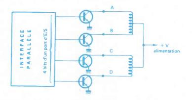
Bobinages et circuit d'interfaçage d'un moteur pas à pas
