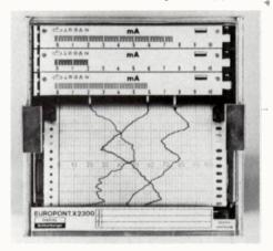
Ils utilisent une technologie modulaire permettant de nombreuses combinaisons, pour une grande variété d'applications. Ils comportent 1, 2 ou 3 voies de mesure, avec une précision de 0,5 %, un temps de réponse de 0,5 s. Ils existent en 3 dimensions frontales : 144 x 144 mm (X 2000), 192 x 240 mm (X 4000), 192 x 288 mm (X 5000). Ils offrent 10 vitesses de défilement et permettent la mesure de grandeurs électriques continues en direct et alternatives par transducteurs.
