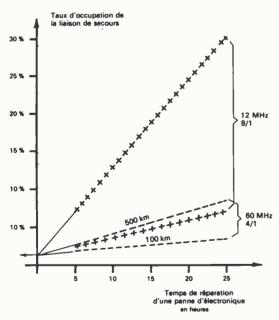
Fig. 13. – Taux d'utilisation des liaisons de secours dans un réseau maillé.
