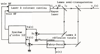
Fig. 2. - Schéma de principe d'un asservissement de la fréquence d'un laser.
