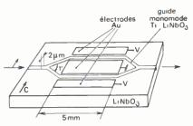
Fig. 2.: Modulateur d'amplitude
