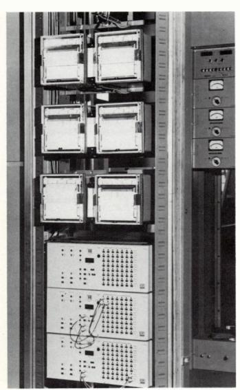
Fig. 6. – Enregistreur et centralisateur de mesures.
