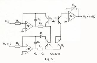
Aucune résistance de précision n'est nécessaire; sur 4 décades en entrée (30 mV à 10 V) l'erreur en sortie reste inférieure à 1,5 %. En tout état de cause, l'erreur ramenée à la pleine échelle (ainsi qu'ont coutume de procéder les fabricants) est inférieure à 0,5 %.
