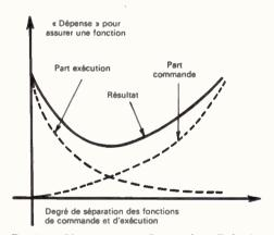
Fig. 1. - Séparation entre Commande et Exécution.
