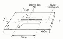
Fig. 1.: Modulateur de phase
