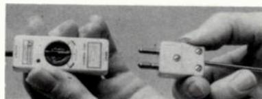
La jonction miniature froide MCJ est une jonction automatique de compensation du point froid des circuits de thermocouple. Cette jonction extrêmement versatile est alimentée par pile. Elle constitue l'équivalent électrique d'un bain de glace à 0 °C. Elle est calibrée en usine et elle est disponible pour la plupart des types de calibration de thermocouple.
