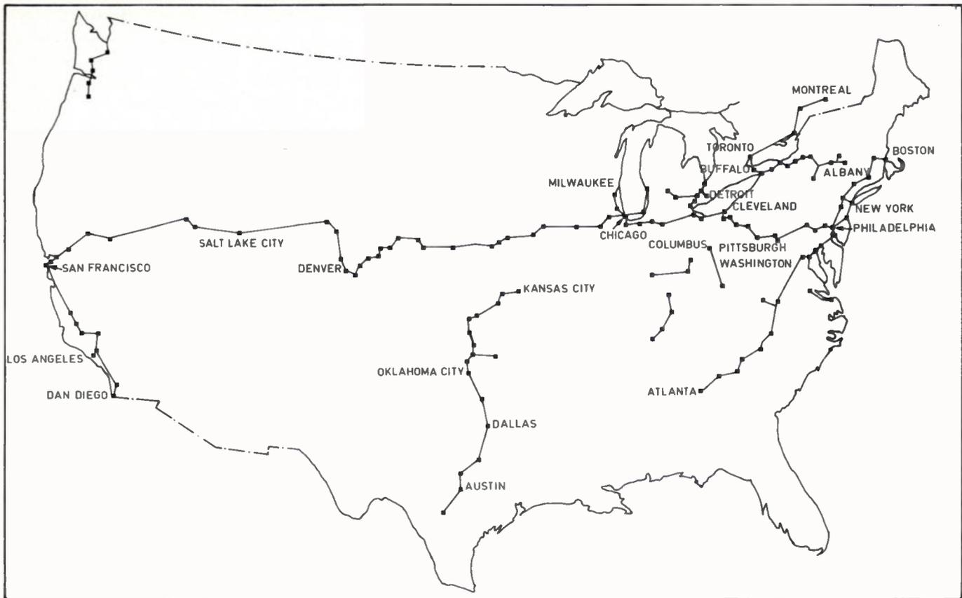
Fig. 9. — Le premier réseau de transmission à longue distance par phares hertziens pour télévision aux USA (d'après Télé-Tech, vol. 12, février 1953).
