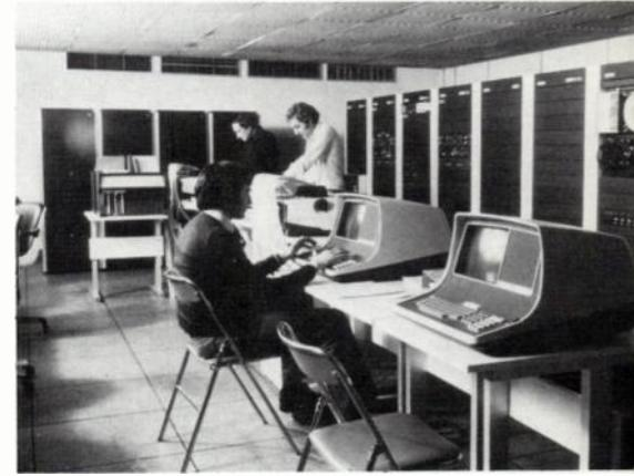
Salle ordinateurs de la raffinerie ELF de Grandpuits; trois mini-ordinateurs SOLAR 16-65 de SEMS assurent la conduite des unités de raffinage et quatre SOLAR 16-40 sont utilisés pour les stockages-mélanges, les expéditions et le réseau anti-pollution.
