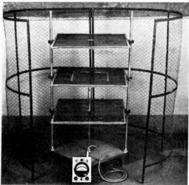
Fig. 8 A. — Chambre d'ionisation absolue dont les électrodes sont constituées par des grillages à mailles larges, pour diminuer l'effet de paroi, et le gaz ionisé par de l'air.
