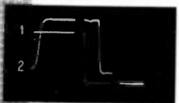
Impulsions 1\mu s avec marquage toutes les micro-secondes 1) sans ligne de retard 2) avec ligne de retard
