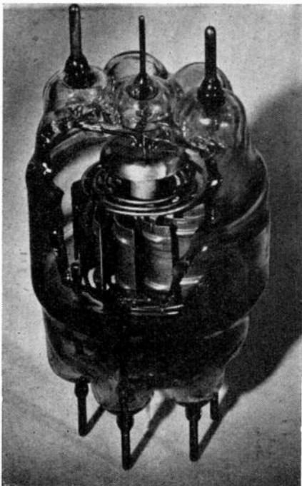
L'ouverture du verre permet de distinguer les trois anneaux qui relient les trois groupes de quatre segments d'anode. La capacité entre deux plaques consécutives est de 1,5 P F. Pour que les anneaux formant le strapping présentent une self de réactance négligeable par rapport à celle des capacités,
