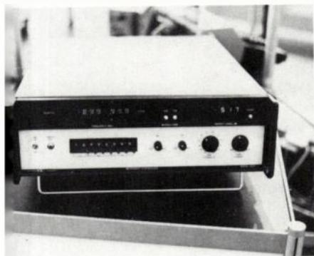
à 18 GHz (de 50 MHz à 18 GHz sur option). Cet appareil dispose d'un niveau de sortie entre + 3 dBm et + 8 dBm suivant les configurations. Sa résolution est de 1 kHz dans toute la bande; toutefois, il possède, en standard une entrée synthétiseur de 1 à 2 MHz. Par le biais d'un synthétiseur BF externe, la résolution peut être ramenée à 0,1 Hz. Le
