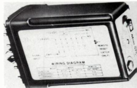
sortie alarme est un relais RT 10 Ampère. L'ajustement du seuil est réalisé par un potentiomètre 20 tours. La répétabilité est de 0,5 % de la pleine échelle.
