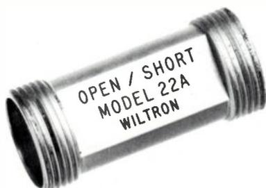
particulier de l'analyseur scalaire modèle 560. La moyenne des mesures effectuées en court-circuit et en circuit ouvert est mémorisée et, ensuite, soustraite de la mesure effectuée. A noter que le circuit ouvert et le court-circuit sont exactement dans le même plan de phase.
