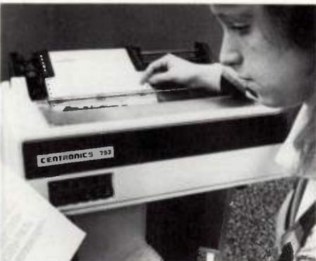
La firme **Centronics Data Computer France** annonce la sortie de son modèle 753, une imprimante par réseau de points à haute densité pouvant fonctionner à une cadence de 120 à 145 caractères par seconde. La machine compense automatiquement les disparités de taille des caractères en ajustant la largeur des lettres. La tête imprimante mobile de  $n \times 9$  points crée des caractères selon
