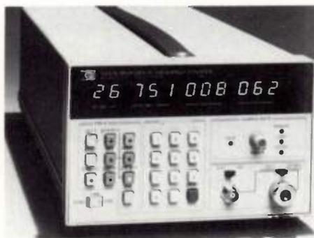
afficheur à 11 chiffres il permet de mesurer jusqu'à 26,5 GHz avec une résolution de 1 Hz. Le clavier, permet à l'utilisateur de choisir un coefficient multiplicateur, un nombre entier M, qu'il applique aux mesures de décalage ou de fréquences, B pour résoudre l'équation  $y = Mx \pm B$ . Cette fonction est particulièrement intéressante lorsqu'en hyperfréquence on cherche à afficher la fréquence porteuse à partir de l'oscillateur
