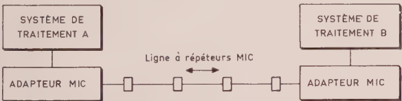
FIG. 3. — Configuration minimale pour la transmission de données sur les lignes MIC.
