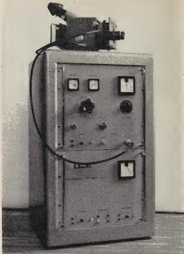
FIG. 2. — Générateur d'impulsions haute tension et caméra convertisseur d'images.
