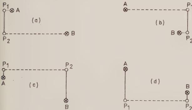
FIG. 18. — Le programme peut également rechercher des tracés utilisant des points de passage extérieurs au rectangle construit sur *A* et *B*.
