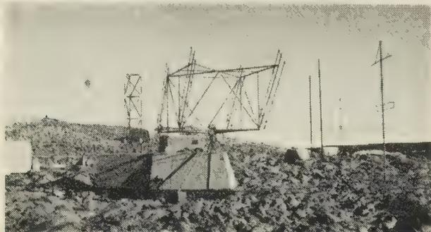
Fig. 1. — Antennes des riomètres installés en Terre Adélie pour les A.I.S.C.
