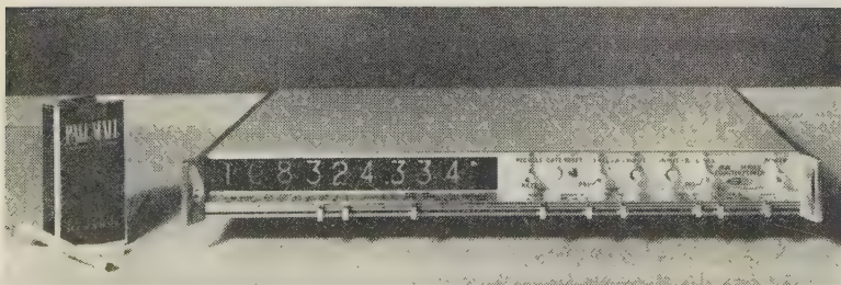
FIG. 9. — SYSTRON DONNER : Fréquence-mètre
