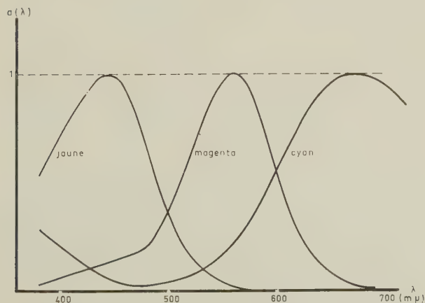
FIG. 2. — Courbes d'absorption typiques des trois couches colorées pour un film inversible.
