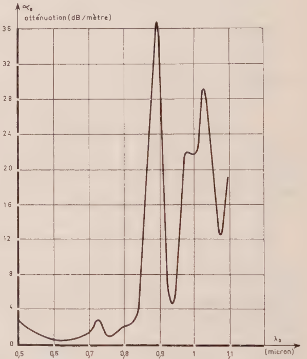
FIG. 13. — Atténuation dans le polyméthyle métacrylate (plexiglass) [3].
