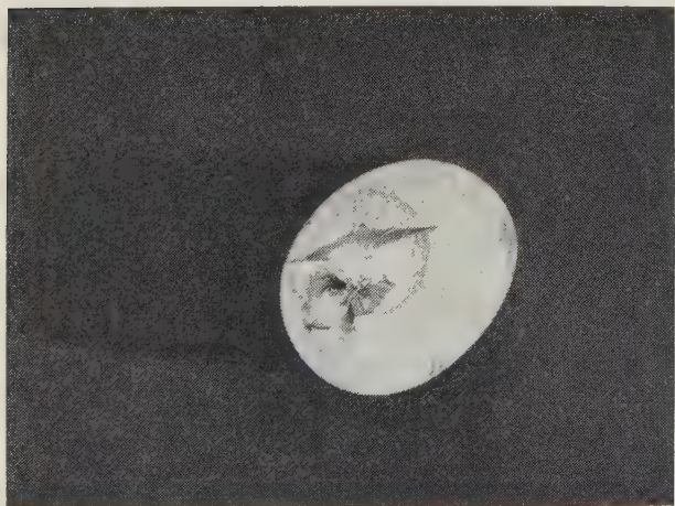
FIG. 12. — Section d'un barreau laser brisé en fonctionnement.
