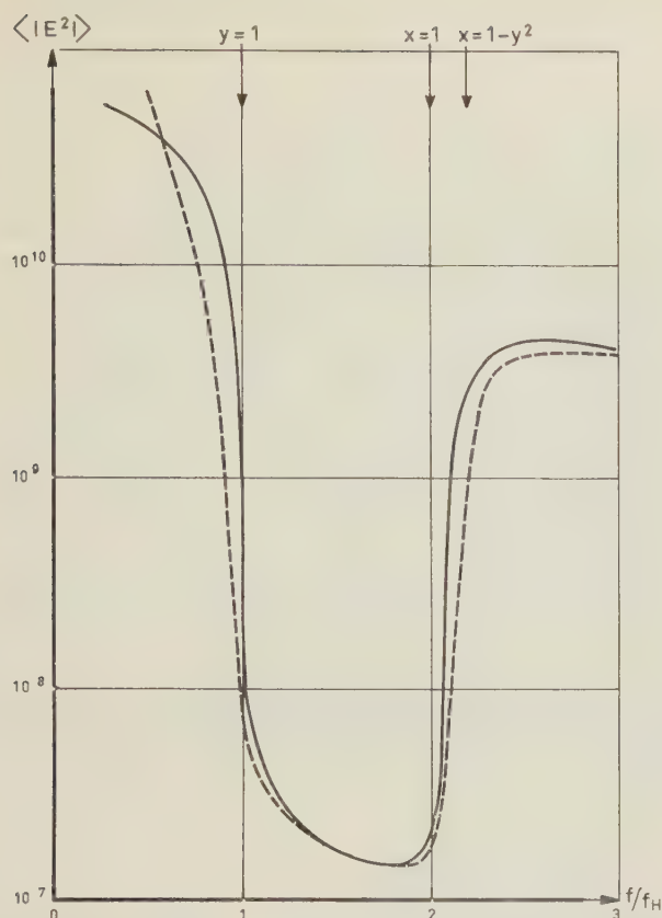
FIG. 4. — Contribution des ondes de plasma à la moyenne quadratique du champ électrique de bruit thermique dans un plasma anisotrope. La courbe en trait plein est relative à la composante E_z parallèle au champ magnétique terrestre (équation (64)), et la courbe tirée est relative à la composante normale E_x (équation (65)). En abscisse est porté le rapport de la fréquence d'observation à la gyrofréquence f_H . Dans cet exemple, nous avons pris f_N/f_H = 2 , v/f_H = 0,01 et \beta^2 = 10^{-7} .
