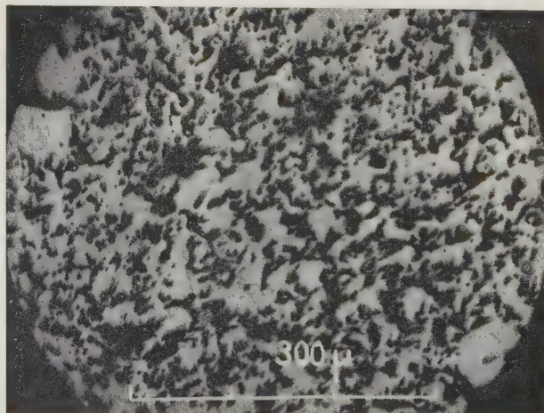
FIG. 1 et 2. — Deux micrographies d'anodes de tantale obtenues par frittage de poudres de structures différentes (métal en blanc).
