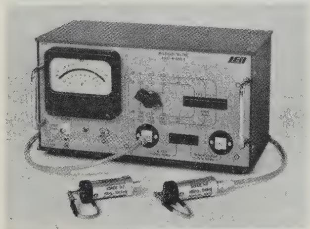
FIG. 41. — LEA. Microvoltmètre, type EVT 1.
