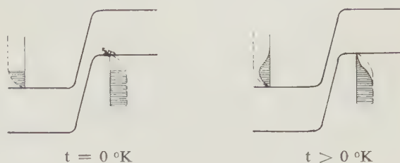
FIG. 3. — Diagrammes de bandes d'une diode tunnel.
