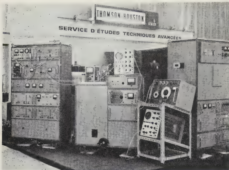
Un maser hyperfréquence (20 dB, 35 MHz de bande passante, 35 °K de température de bruit) présenté par la Compagnie Française Thomson-Houston.
