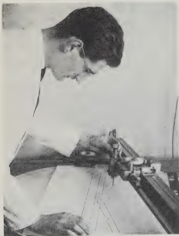
FIG. 2. — Coordinatographe. Réalisation d'un dessin modèle au coordinatographe. Cet appareil permet de dessiner et d'effectuer tous contrôles sur la géométrie des circuits imprimés avec une précision de \pm 3/100 .
