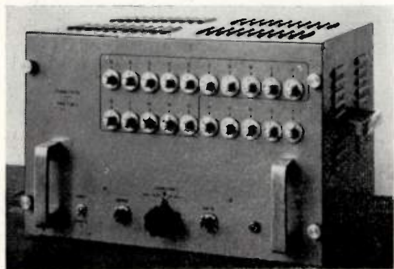
FIG. 3. — Correcteur à ligne de retard. Vue générale
