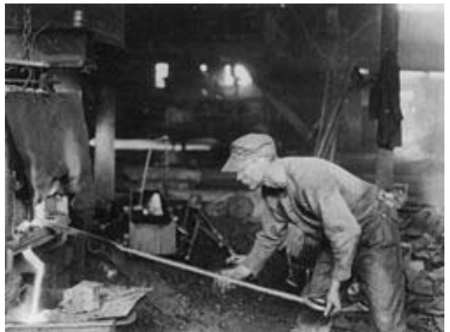
Un puddleur coulant le laitier hors du four de puddlage après avoir extrait les boules de fer
