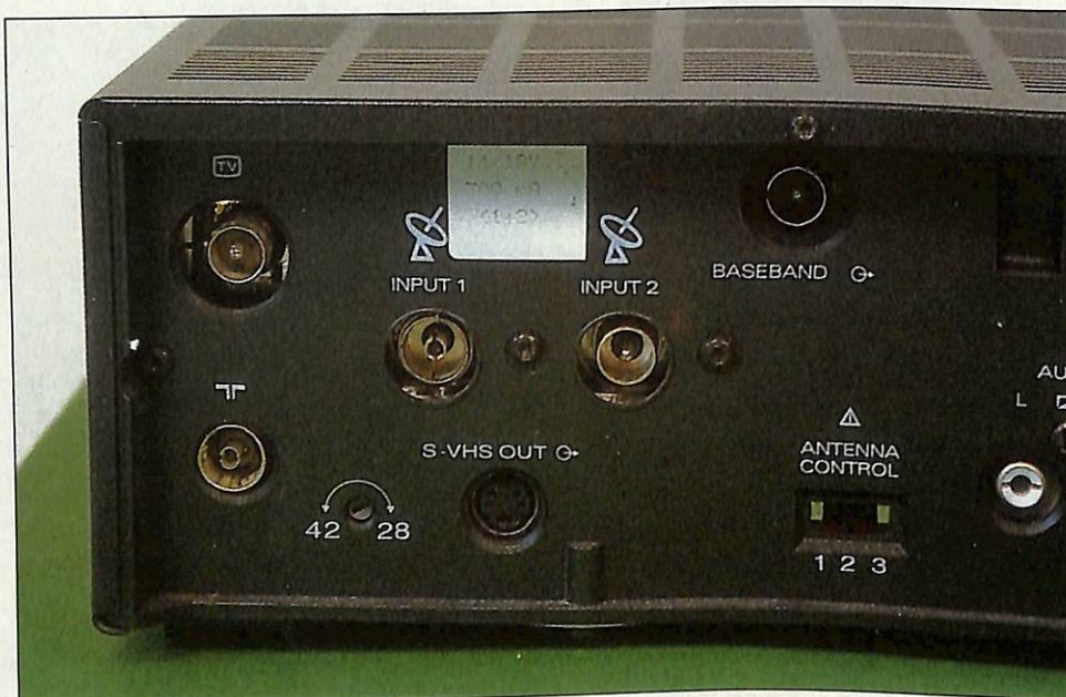
Un récepteur satellite à deux antennes. Ici, le constructeur utilise deux prises CEI différentes, on ne peut inverser les antennes ; une prise RCA sort la bande de base et une S-vidéo chrominance et luminance, car ce récepteur est équipé d'un démaqueur.
