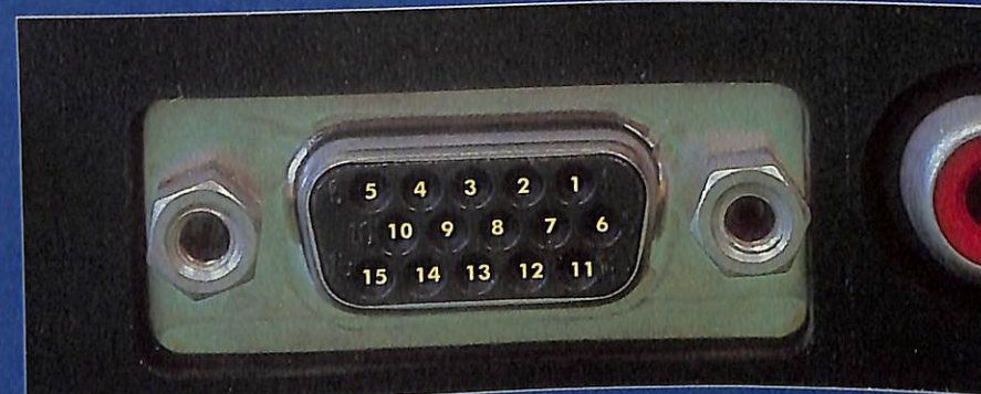
La prise Sub-D haute densité (il existe une sub D normale, plus large et à deux rangées de contacts).
