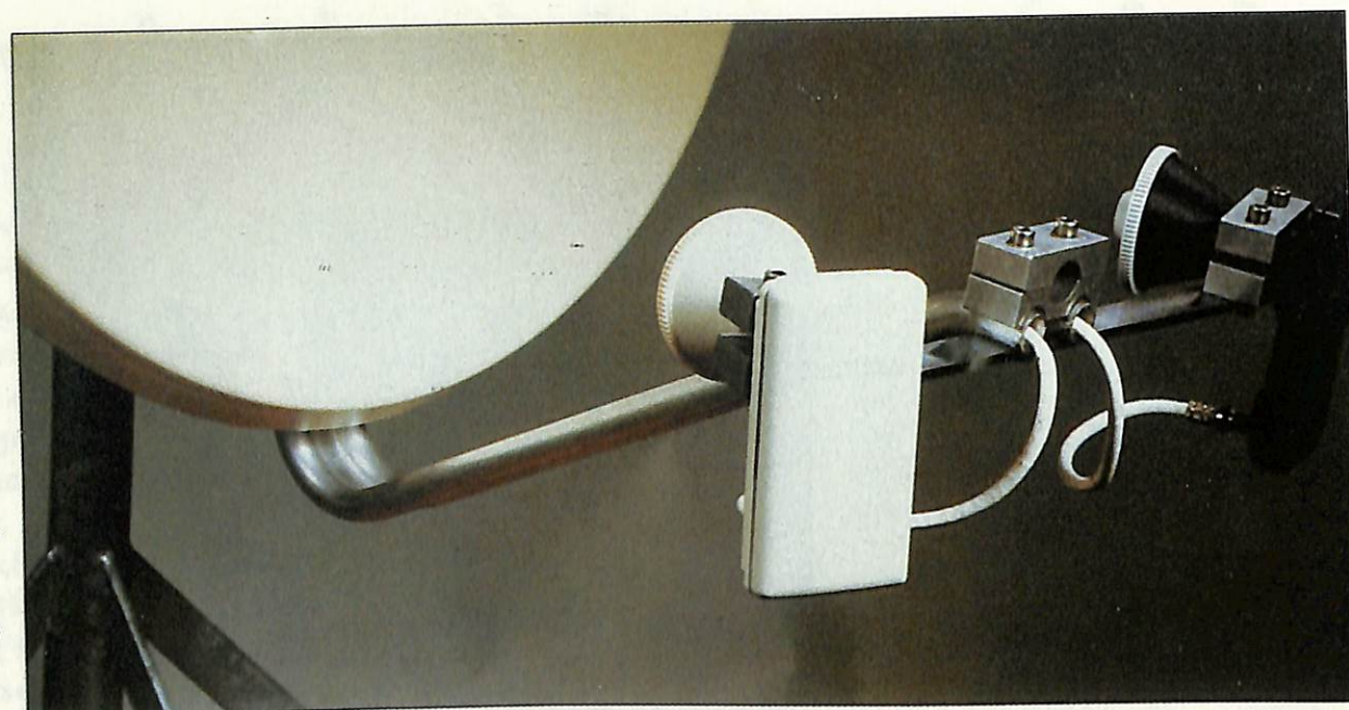
Deux têtes réceptrices pour capter deux satellites (voisins l'un de l'autre) avec une seule antenne parabolique. (Doc. METRONIC)
