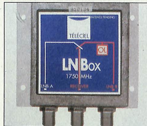
Un coupleur pour bande Télécom, dû à LN Box (Teleciel) type T. COM.
