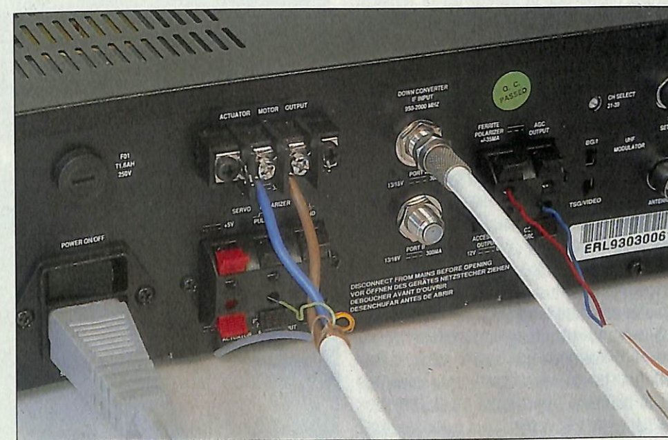
Les raccordements d'un récepteur satellite associé à une parabole motorisée. De gauche à droite, l'alimentation secteur, la liaison avec le détecteur de position de l'antenne (fil vert et jaune), l'alimentation du moteur (bleu et marron), le câble coaxial blanc et les fils rouge et bleu pour le polariseur ferrite.
