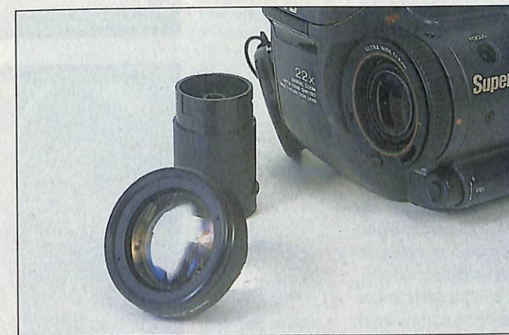
Une commande originale pour le diaphragme, un bouton avec touche centrale, la mise au point manuelle passe par la bague. L'optique se démonte pour passer en vrai grand angulaire, un tube s'intercale pour le mode micro.
