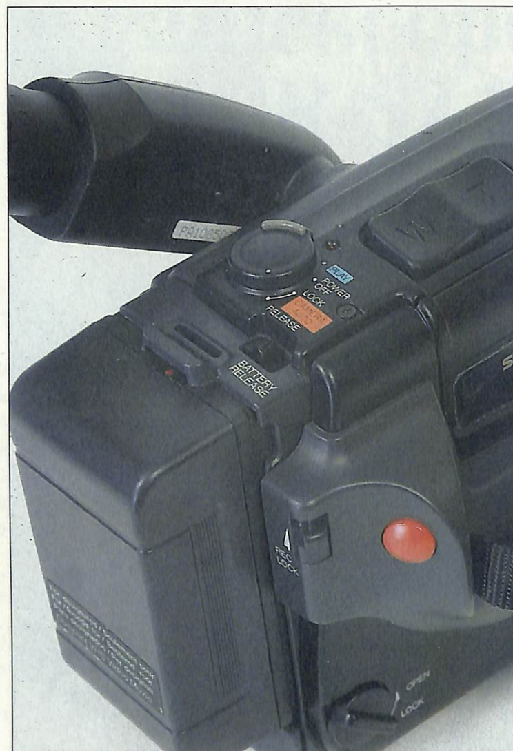
Classique : la touche rouge pour le début d'un enregistrement. Sur le dessus, le sélecteur enregistrement / lecture dispose d'une position « tout automatique » pour laquelle les touches du caméscope sont inhibées...
