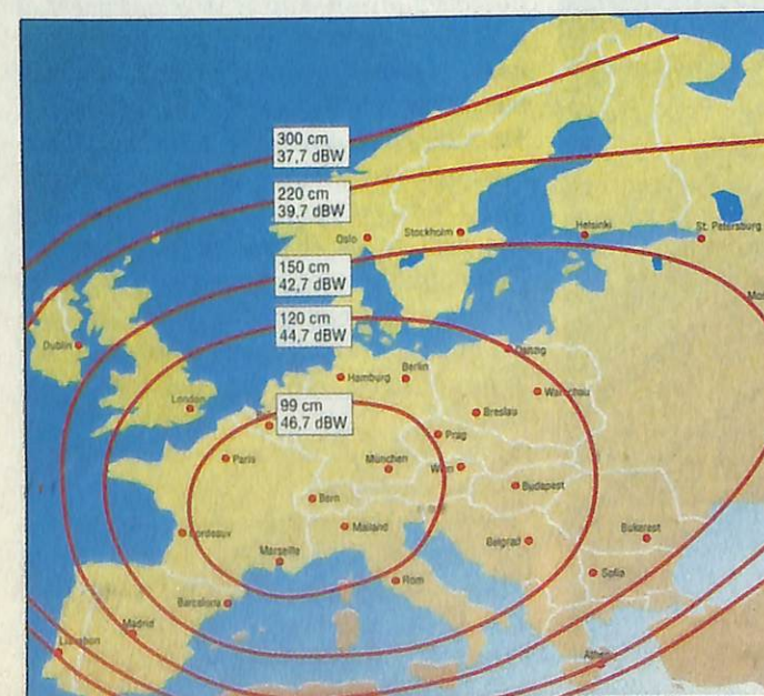
Diamètre des antennes nécessaires pour recevoir le satellite Intelsat 601, 27,5° W (ici faisceau Est)
