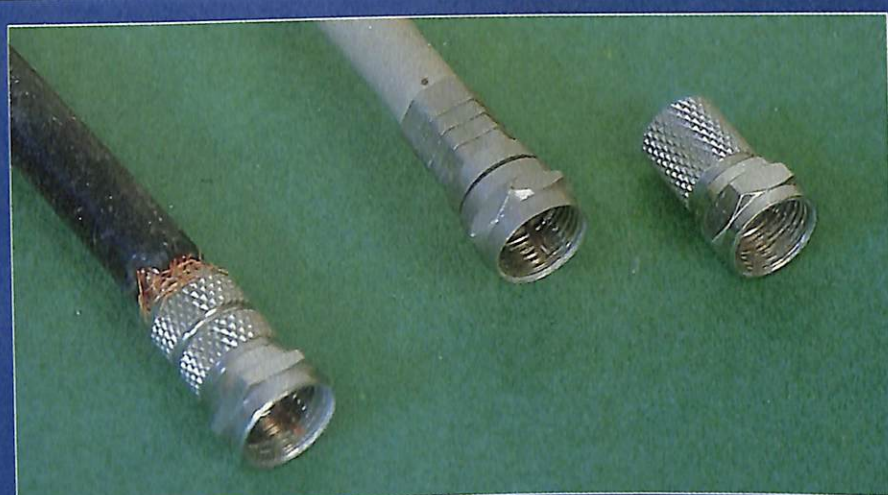
La prise F, sertie ou vissée : elle utilise l'âme du coaxial comme contact central.
