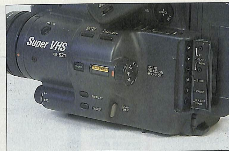
Pas mal de touches , certaines sont cachées par le viseur ou un volet. Le gros bouton sélectionne un mode de prise de vues qui entre en service par pression sur une touche centrale.
