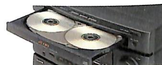
Platine laser 3 CD En ouvrant le tiroir, on peut changer 2 des 3 CD tandis que la platine continue à lire le troisième.
