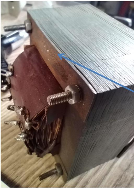
D'abord on contrôle le transformateur d'alimentation. Ses tôles ne sont pas droites. On resserre à l'étau. Un boulon est cassé, on le remplace. Puis repose, et constat qu'il est presque trop petit. Peut être pas le transfo d'origine? Ses tensions sont OK.
