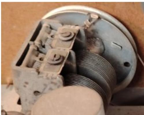
LE CV (Condensateur Variable) est testé, puis sera nettoyé au pinceau, soufflette et KF2. Il est OK.
