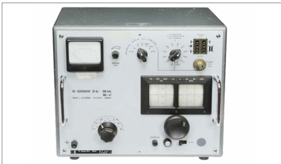
Figure 4. Le générateur MC-47 de Wandel & Goltermann est le pendant du SRB de R&S, mais sa gamme de fréquences est plus étroite et il possède plus de sorties symétriques, dissymétriques et isolées (transformateur).
