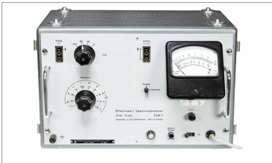
Figure 7. Le voltmètre audio Wandel & Goltermann ESM-1 de plage 30 Hz à 15 kHz, photographié ici avec le cadran incliné.
