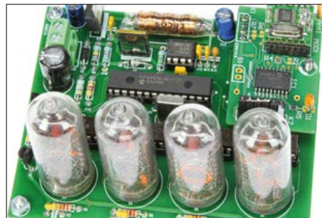
Figure 5. Le récepteur installé sur le circuit imprimé des Nixie en remplacement du capteur.
