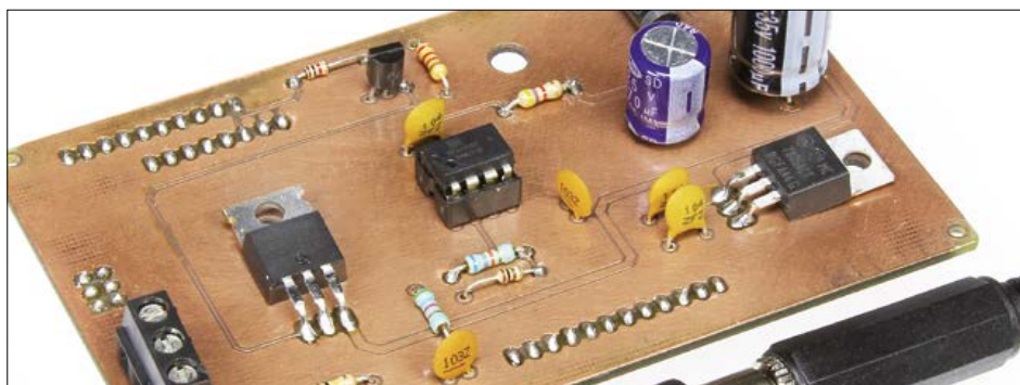
Figure 3. Le prototype de carte d'extension réalisé par le laboratoire. Le circuit imprimé a été fraisé !
