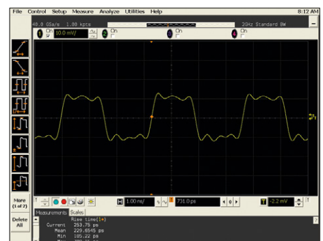
Figure 6. Mesure d'un signal d'horloge à 300 MHz avec un oscilloscope de 2 GHz.
