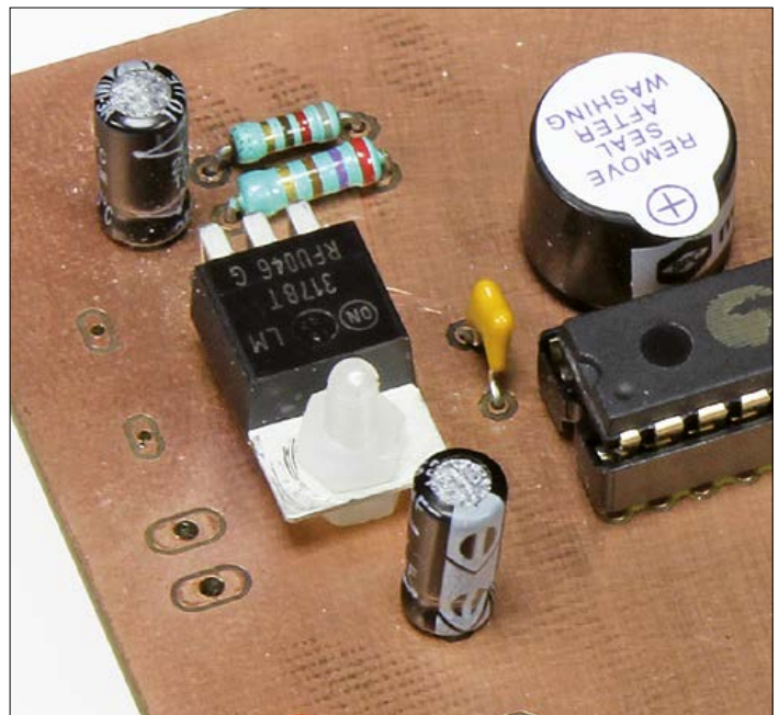
Figure 6. On distingue le montage du régulateur à quelque distance de la surface cuivrée.
