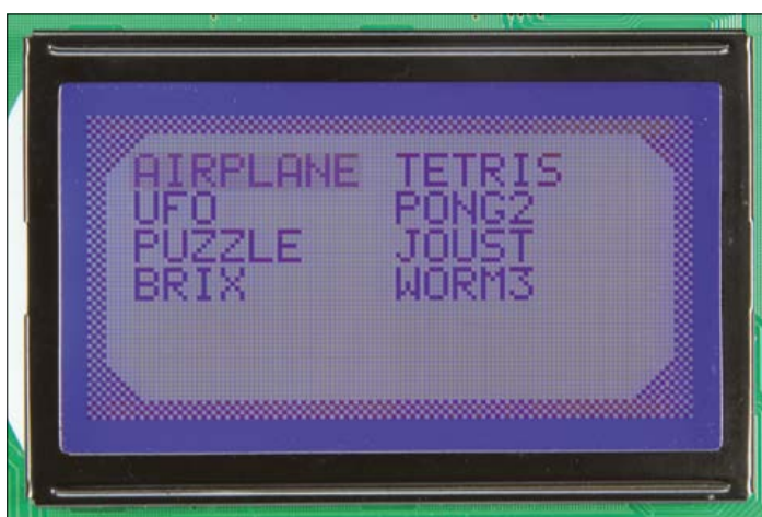
Figure 7. Menu de sélection des jeux que le PSoC trouve dans l'EEPROM.
