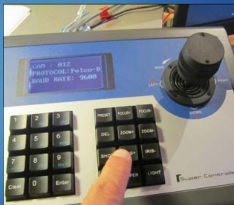
Figure 1. Ce clavier avec manette à trois axes permet de piloter les caméras PTZ.
