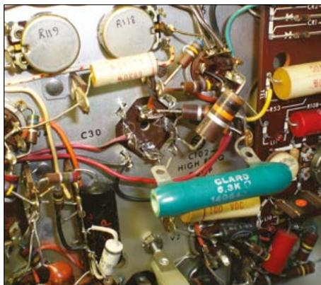
Figure 15. Le remplaçant de C30 installé et les composants alentour remis en place.
