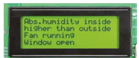
Figure 4. Le robot aérateur vous livre ici en alphanumérique quelques-uns de ses paramètres.
