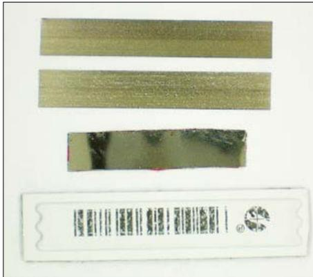
Figure 1. Une étiquette AM est faite de deux résonateurs et d'un ruban magnétique (plus court).
