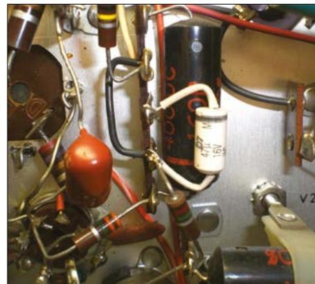
Figure 11. Le remplaçant de C107 monté au-dessus de C23.
