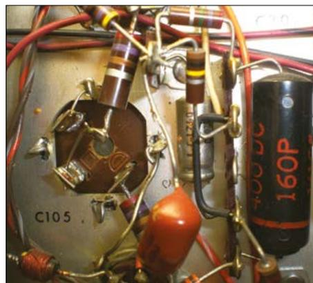
Figure 10. C107 (boîtier argenté) est caché sous des composants et un cavalier.
