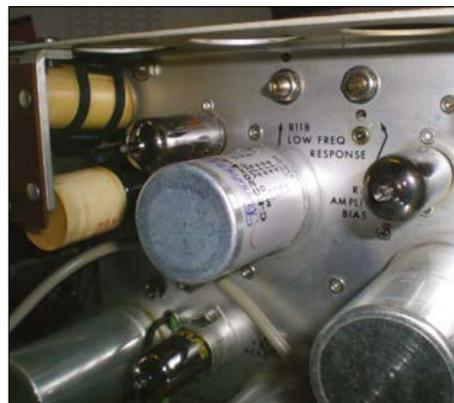
Figure 16. Le remplaçant de C30 installé, côté boîtier.
