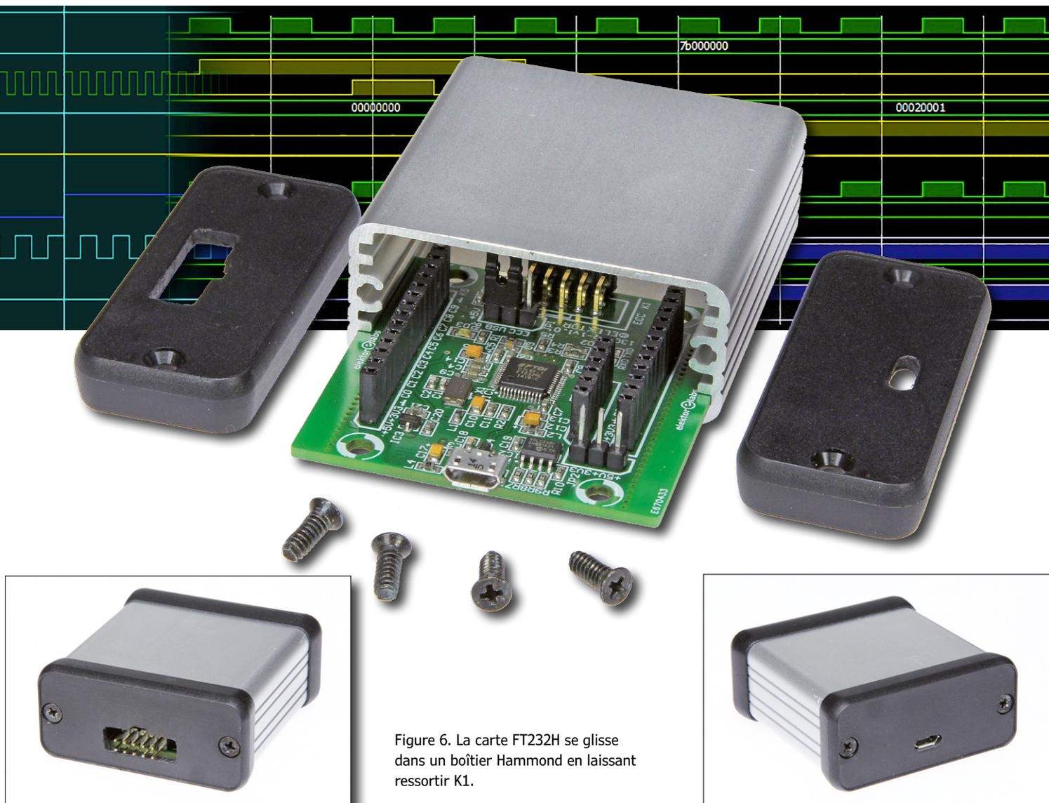
Figure 6. La carte FT232H se glisse dans un boîtier Hammond en laissant ressortir K1.
