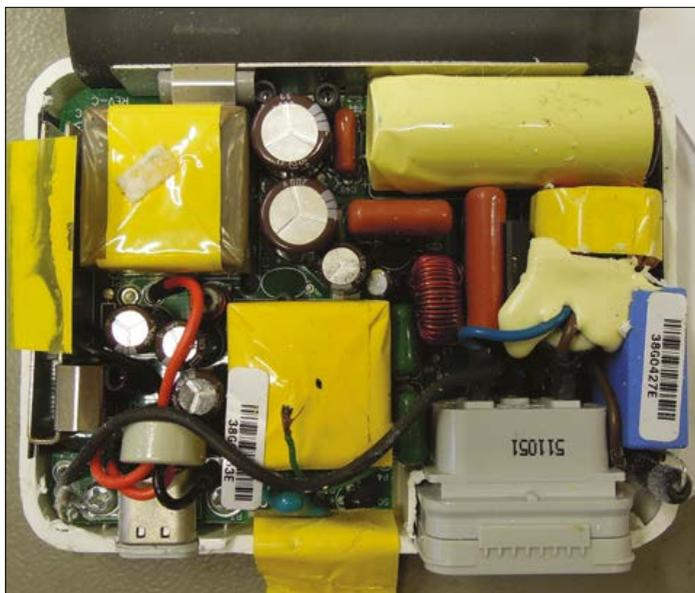
La chaleur est dissipée par deux bandes métalliques placées sur deux bords de la carte. L'une refroidit la diode de redressement du circuit de sortie, l'autre ce que je présume être un FET de commutation pour le circuit PFC, par ailleurs basé sur un L6561D de ST Microelectronics. Je n'ai pas cherché à lire la référence du FET, pour cela il aurait fallu retirer un transformateur et cela ne m'a pas semblé en valoir la peine.
