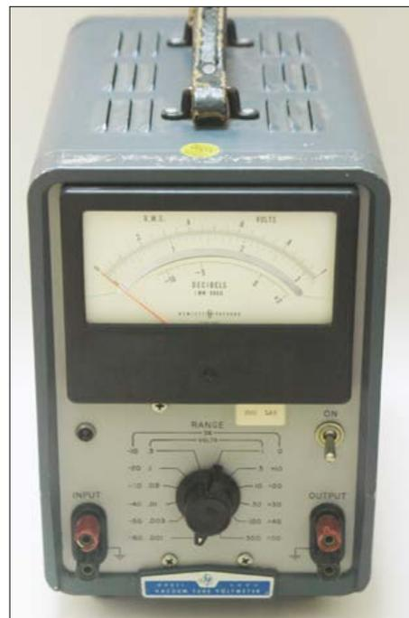
Figure 2. Face avant du HP 400H.
