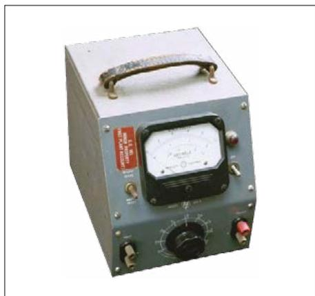
Figure 1. L'original : le VTVM HP400A.
