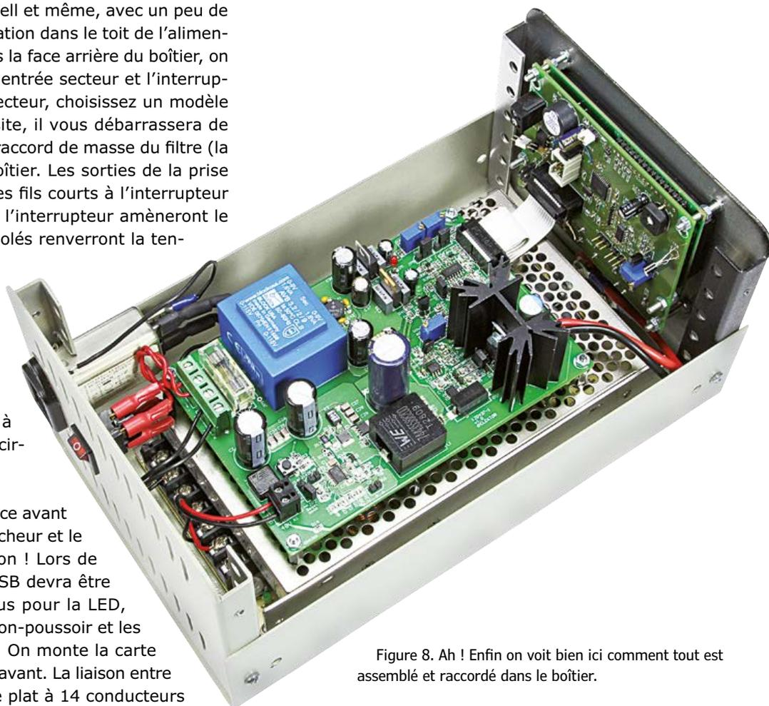
Figure 8. Ah ! Enfin on voit bien ici comment tout est assemblé et raccordé dans le boîtier.
