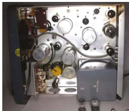
Figure 5. Châssis nettoyé mais V9 s'est brisé à sa base.
