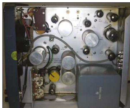
Figure 4. Fuite d'un condensateur et surchauffe.
