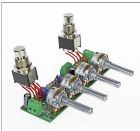
Figure 3. Ce prototype montre bien comment raccorder les commutateurs.
