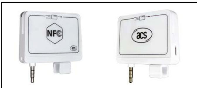
Deux interfaces sont disponibles : l'habituel connecteur USB assurant une compatibilité PC/SC et CCID (pilote générique), mais aussi et surtout un jack 3,5 mm à 4 circuits. Enfiché dans le connecteur audio d'un *smartphone* ou d'une tablette (ou d'un autre appareil compatible), ce jack assure les communications avec le lecteur par échange bidirectionnel de données Manchester venant moduler une porteuse d'environ 2500 Hz. Comme pour dialoguer avec un capteur externe ou un Arduino, en somme.
