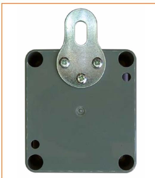
Figure 5. Le prototype de l'auteur, dans un boîtier étanche et muni d'un solide crochet vissé.
