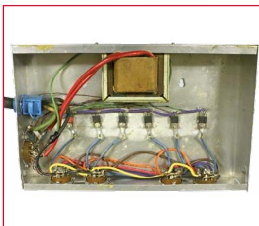
Figure 3. Le boîtier déporté contenait les triacs pour commuter les lampes. En bas se trouvent les prises pour les connexions aux barres de lampes ; le câble en provenance de la console se branchait sur la prise en bas à gauche. Le transformateur fournissait une tension alternative abaissée à la console.
