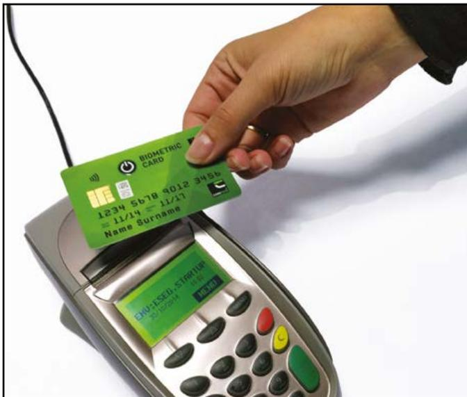
Une autre approche, présentée par l'italien **Card Tech**, consiste à intégrer dans la carte elle-même un capteur biométrique souple (du norvégien **IDEX**) avec sa batterie. Sa puce RFID ne s'activera ainsi que si elle est tenue par son utilisateur légitime. C'est séduisant sur le plan technique, forcément un peu cher, mais riche d'applications dans de multiples domaines, bien au-delà de la monétique : les cartes d'électeur, par exemple.
