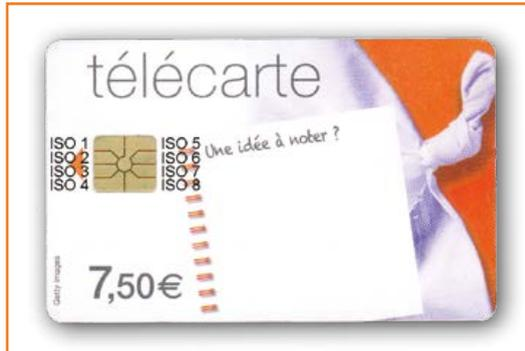
Figure 1. Disposition des broches du micromodule sur une carte de type T2G
