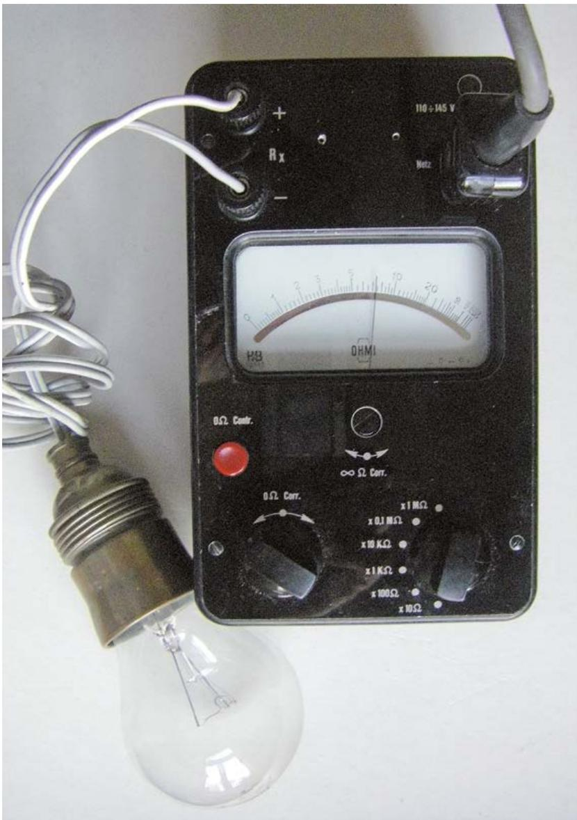
Les lampes à incandescence peuvent faire plus qu'éclairer. Vues comme limitatrices de courant ou de puissance, elles offrent dans de nombreuses situations des avantages que n'ont pas les fusibles « normaux » : alors qu'un fusible voit sa résistance passer brutalement de zéro à l'infini lorsque le courant atteint une certaine intensité, une ampoule peut limiter en douceur la montée d'un courant.
