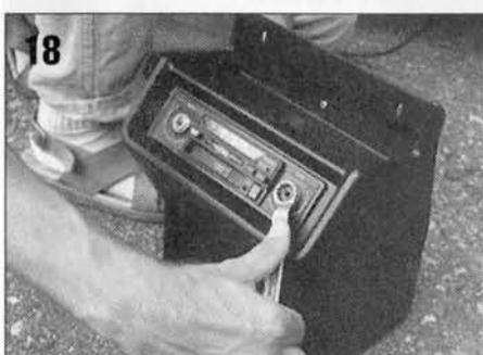
Figure 18 - Monter le cache et serrer les écrous (clef de 14 ou clef spéciale).
