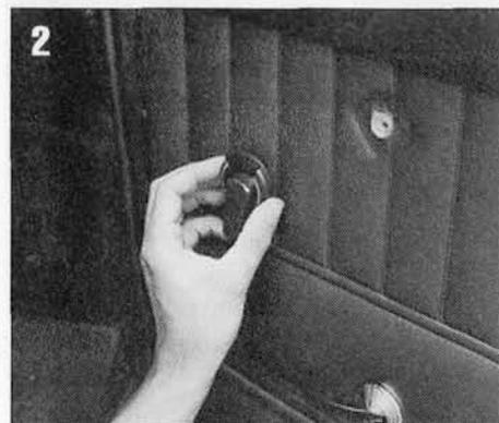
Figure 2 - La manivelle du lève-vitre peut être simplement encliquetée, ou vissée
