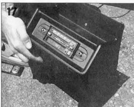
Figure 17 - Il faut choisir la console suivant le modèle d'autoradio: avec deux trous ou avec une découpe rectangulaire unique. Les modèles anciens se montent par l'arrière, les flat nose par l'avant.
