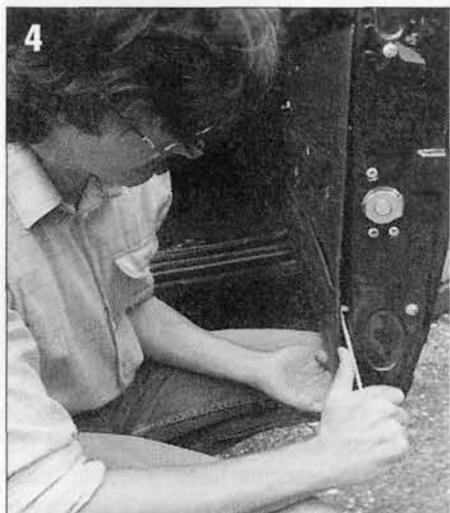
Figure 4 - Attention en soulevant la garniture: on a vite fait de rayer la peinture ou de casser une agrafe. Placez un tournevis à lame large tout près de l'agrafe et soulevez le carton en tournant le tournevis.
