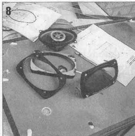
Figure 8 - Visez juste avant de découper le panneau d'habillage! Les vis traversent la grille, le saladier du haut-parleur, l'entretoise (fabrication maison) et le panneau. Elles sont fixées par un écrou, ou une tôle si elles sont auto-taraudeuses. Le haut-parleur est un modèle Visaton à deux voies.
