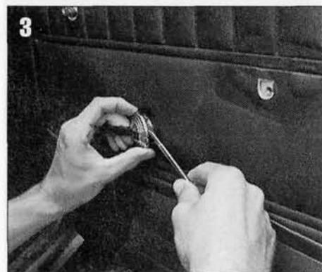
Figure 3 - Souvent on ne trouve la fixation qu'après avoir repoussé l'habillage avec un tournevis plat: la manivelle est retenue par un clip caché par une bague.
