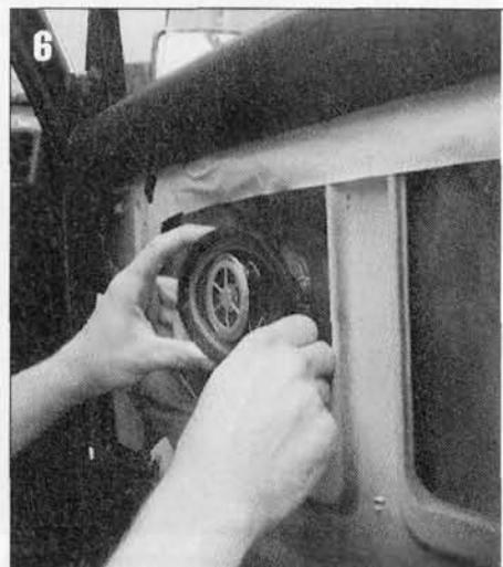
Figure 6 - L'emplacement du haut-parleur est trouvé, mais la profondeur est-elle suffisante? Il ne faut pas entraver le mouvement de la glace et du mécanisme.
