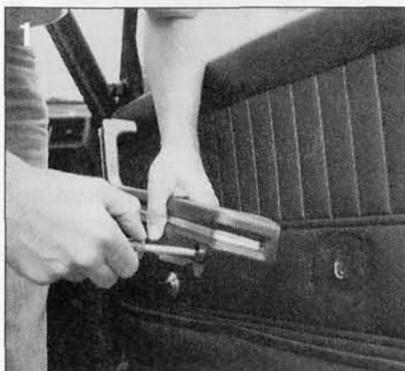
Figure 1 - La patience et le tournevis cruciforme viennent à bout de la garniture intérieure des portières. Si vous ne trouvez pas les vis, regardez sous les baguettes décoratives. Si vous ne les trouvez toujours pas, elles sont remplacées par des agrafes en nylon.
