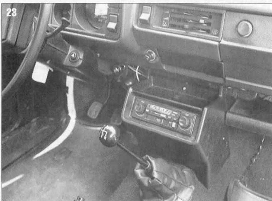
Figure 23 - Après un test complet, la console est remontée en place. On peut savoir maintenant si un antiparasitage est nécessaire.
