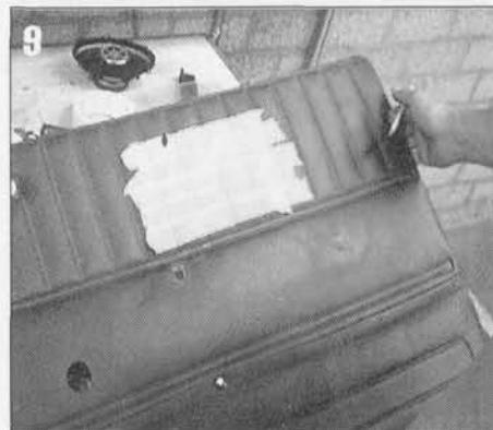
Figure 9 - Pour éviter d'endommager la surface du panneau d'habillage, vous la recouvrirez de ruban crêpe, comme pour la peinture.
